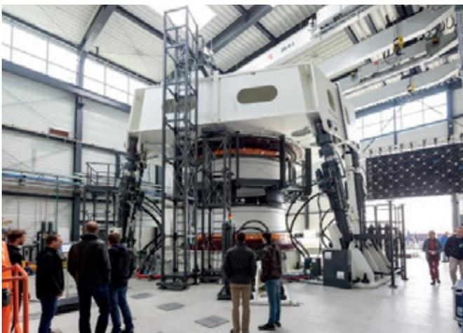
*Prüfstände wie dieser für Großlager des Fraunhofer IWES in Hamburg stehen für die Erprobung von Windantriebssystemen auf Schiffen zur Verfügung*
