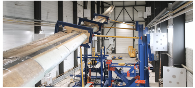
Biaxialer Ermüdungsprüfstand mit Federelement und entkoppelten Massen
