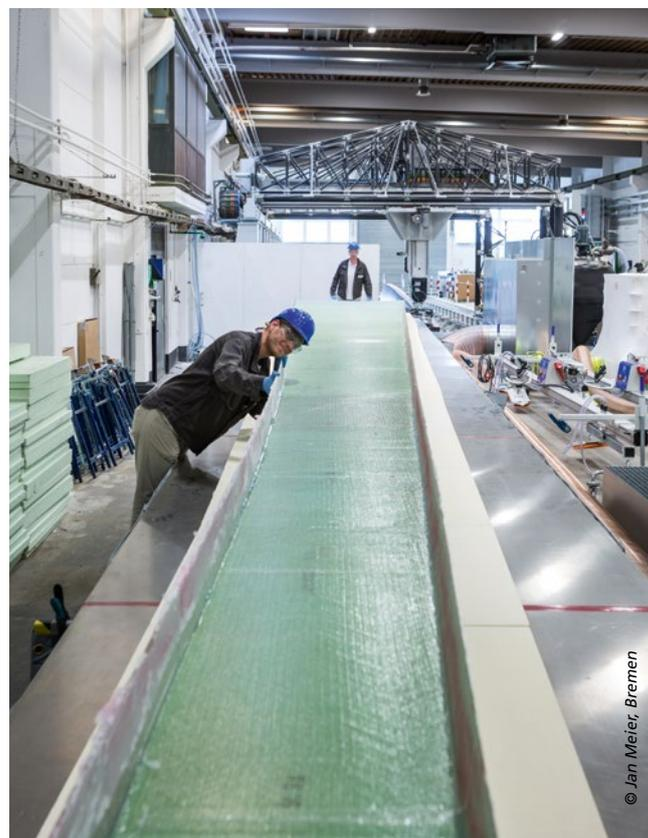
*Letzte Kontrolle des Stegs für den 18 m-Blattabschnitt des 40 m-IWES-Blatts, hergestellt mit Direktinfusionstechnik.*
