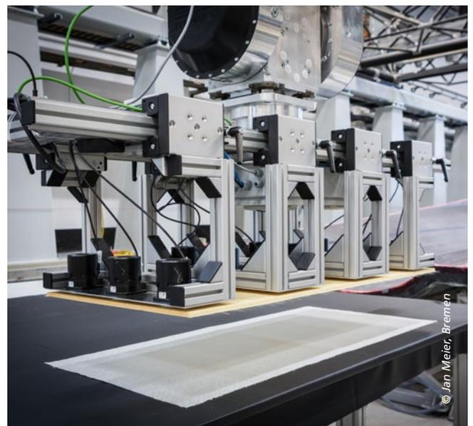
Greifer für automatisierten pick-and-place-Prozesse, im Bild der Einzellagengreifer, für gestapelte und größere Zuschnitte sowie konsolidierte Preforms.
