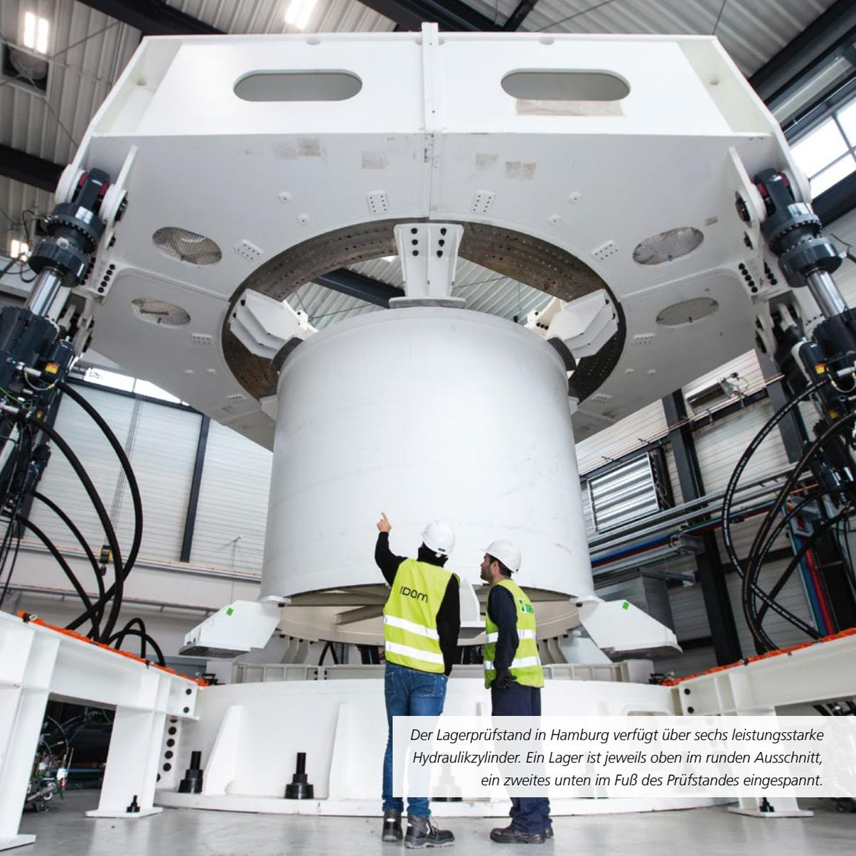
*Der Lagerprüfstand in Hamburg verfügt über sechs leistungsstarke Hydraulikzylinder. Ein Lager ist jeweils oben im runden Ausschnitt, ein zweites unten im Fuß des Prüfstandes eingespannt.*
