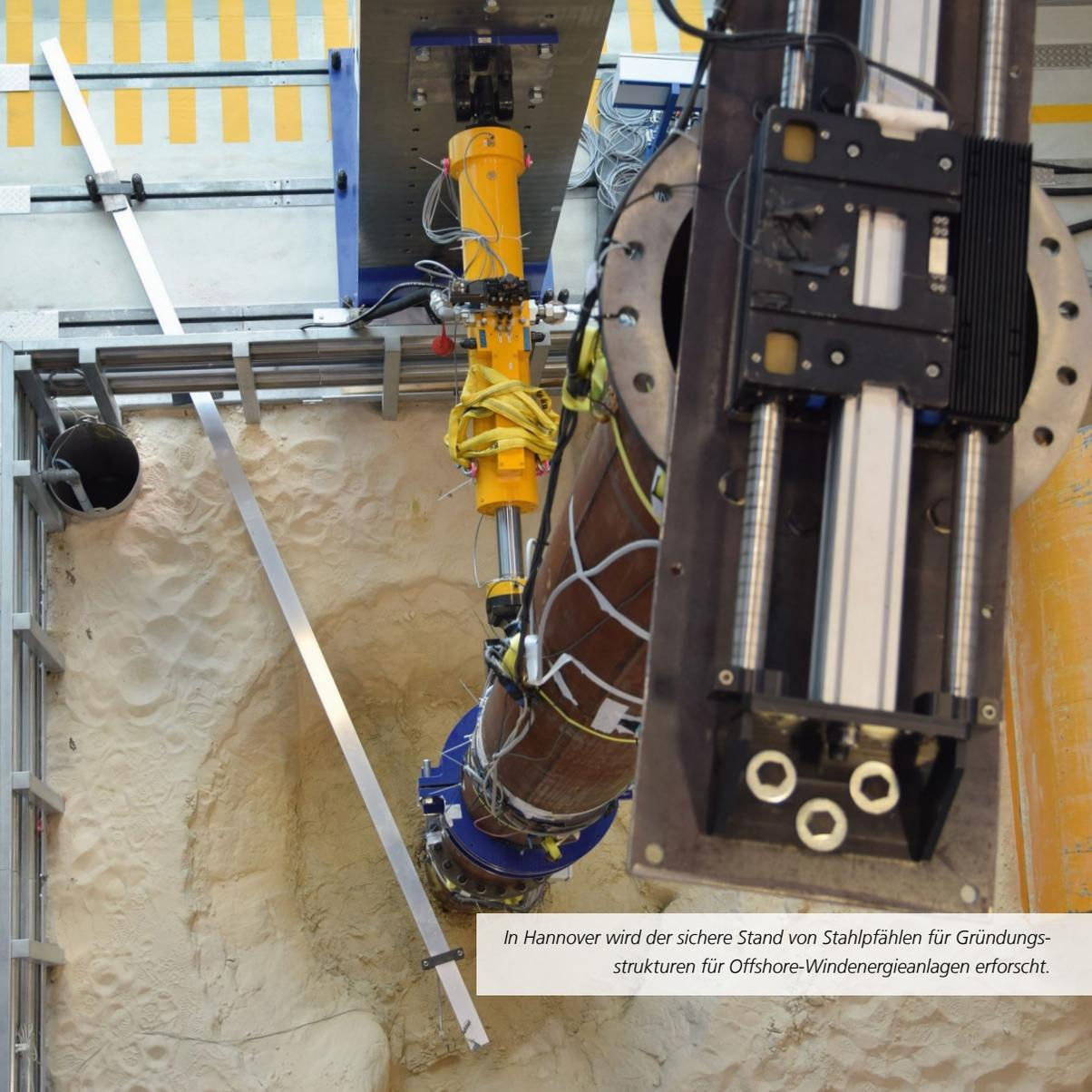
*In Hannover wird der sichere Stand von Stahlpfählen für Gründungsstrukturen für Offshore-Windenergieanlagen erforscht.*
