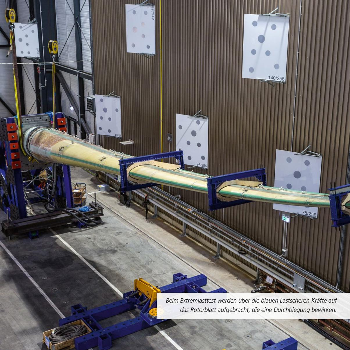
*Beim Extremelasttest werden über die blauen Lastscheren Kräfte auf das Rotorblatt aufgebracht, die eine Durchbiegung bewirken.*
