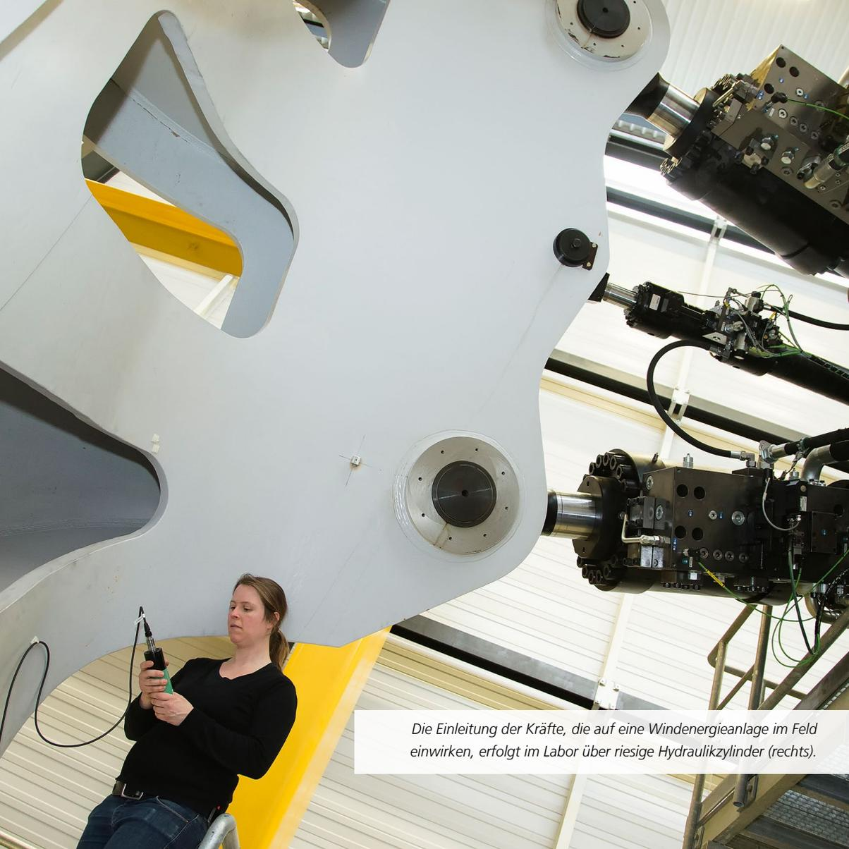
*Die Einleitung der Kräfte, die auf eine Windenergieanlage im Feld einwirken, erfolgt im Labor über riesige Hydraulikzylinder (rechts).*
